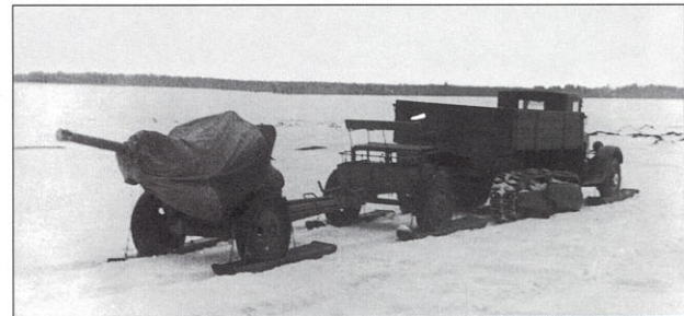
ЗИС-22-52 с лыжами на передних колесах буксирует по снежной целине 122-мм гаубицу М-30 с передком (в в е р х у) и установленную на лыжах 76-мм пушку Ф-22УСВ с передком (в н и з у). Соответствен-но, февраль и март 1941 года
