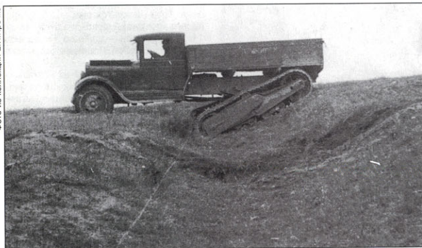
ЗИС-22-52 преодолевает на испытаниях канаву шириной 4,6 м и глубиной 0,9 м. Сентябрь 1940 года
